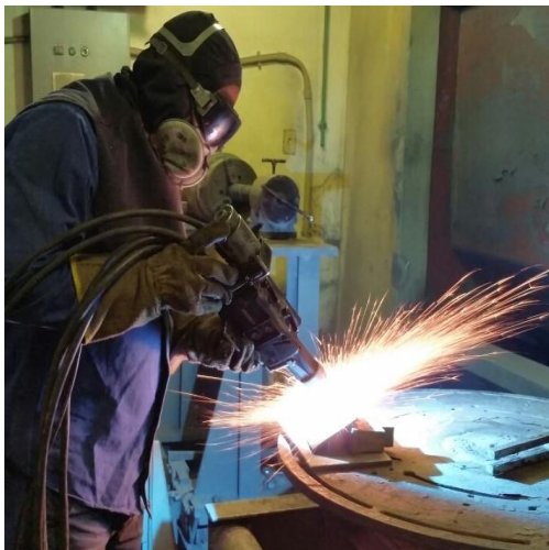
Figura 17 – Aplicação do revestimento nas amostras retangulares.
